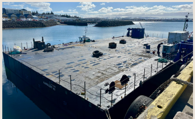
Pramminn er notaður til að flytja staurana frá Kópavogshöfn að landfyllingunni á norðanverðu Kársnesi.
